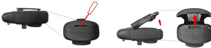
Zum Öffnen des Batteriefachdeckels schieben Sie den Deckel unter leichtem Druck Richtung Gewindeschraube.
