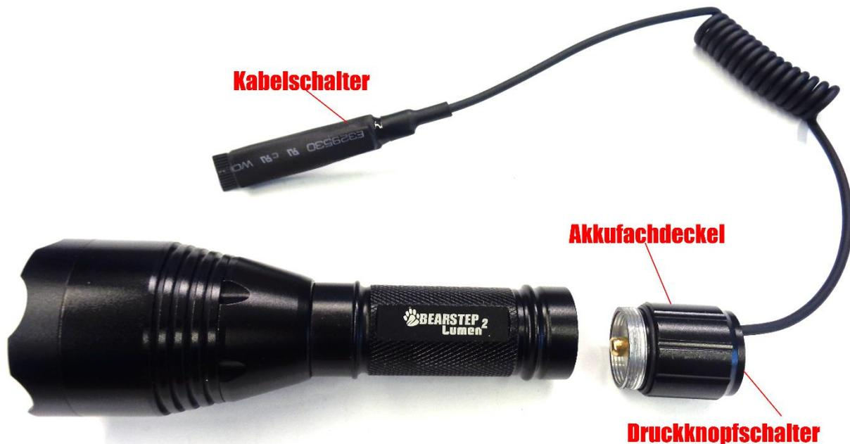
Für den Betrieb der Taschenlampe ist 1x Akku 18650 erforderlich. Um der Akku einzulegen öffnen Sie das Akkufachdeckel durch aufschrauben. Schieben Sie der Akku in das Akkufach und verschließen Sie dieses durch Aufschrauben des Akkufachdeckels.
