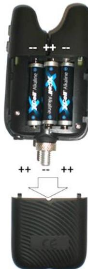
Batterielage/Polung bei geöffnetem Batteriefach
