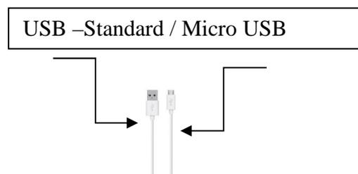
Der im Lieferumfang enthaltene Lithium-Ionen-Akku kann mittels des ebenfalls mitgelieferten USB-Ladekabels aufgeladen werden. Schließen Sie hierzu den Micro USB-Stecker an den Akku an und schließen Sie den USB Stecker an eine entsprechende Stromquelle (z.B. Laptop, PC, geeignetes Netzteil) an, um den Akku zu laden. Durch Drücken des Kontrollknopfes am Akku können Sie die Ladestands-Anzeige des Akkus kontrollieren.
